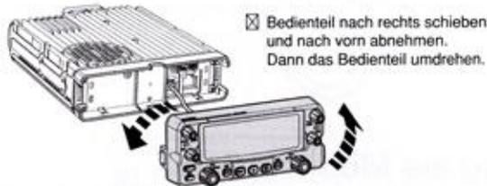
③ Bedienteil so positionieren, dass die Führungen in die Schlitz passen.
